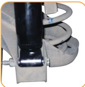
**2** Após essa operação, retire o amortecedor e prenda-o na morsa. Remova a porca que prende o coxim do amortecedor e substitua-o (não esquecendo de realizar o escorvamento). Realize a operação inversa para a montagem do conjunto de suspensão.
