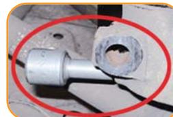
**5** Realize a operação inversa para a montagem do conjunto de suspensão, não esquecendo de retirar a ferramenta de abertura da manga.
