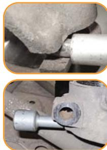
**4** Com o conjunto na bancada, coloque o encolhedor de molas e remova as porcas superior e inferior. Logo após, substitua o amortecedor (não esquecendo de realizar o escorvamento) e efetue a montagem do conjunto observando a sequência correta dos componentes.
