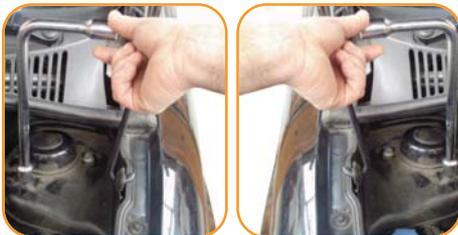
**3** Com o veículo suspenso, remova a porca da bieleta e o parafuso da manga de eixo. Logo após, utilize a ferramenta de abertura da manga para a remoção do Amortecedor.
