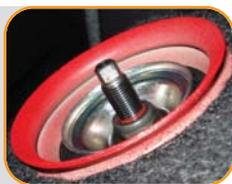
**3** Após essas operações, leve o conjunto amortecedor e mola para a bancada e remova na ordem: mola, calço, coxim do amortecedor, arruela de encosto, batente e coifa do amortecedor.
