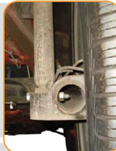
**4** Efetue a substituição do amortecedor e o escorvamento para a montagem no veículo, inverta operação de desmontagem, atentando-se ao aperto final do parafuso inferior e a porca superior dos amortecedores, pois devem ser com o veículo apoiado no solo.
