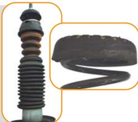
**2** Com o veículo suspenso, apoie o macaco no eixo, retire a porca da haste e apenas alivie a carga do parafuso inferior do amortecedor. Desça o eixo com o macaco, até aliviar a carga da mola. Em seguida, retire o parafuso e o amortecedor.
