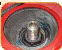
**3** Com o veículo suspenso, remova a bieleta e a cinta de apoio. Logo após, remova também o parafuso da manga de eixo e introduza o expansor da manga. Somente após essas operações, retire o montante completo e o leve para bancada.
