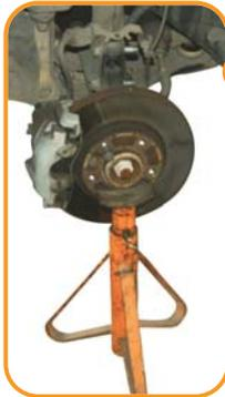
1 Com o veículo suspenso no elevador, retire as rodas e, por segurança, calce o disco de freio em um cavalete, que deve ser usado somente para dar suporte ao disco e não ao veículo.
