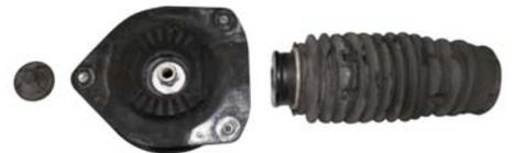
5 Monte todas as peças do conjunto na bancada acompanhando a sequência correta dos componentes e, em seguida, monte o conjunto no veículo, alinhando a posição dos parafusos do coxim que deve ser montado apontando para a traseira do veículo:
