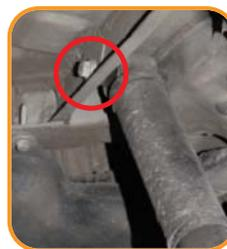
2 Solte os parafusos de fixação inferior e superior do amortecedor e remova-o.
