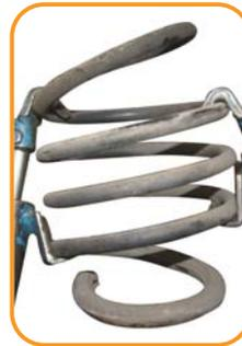
3 Solte os três parafusos superiores do coxim do amortecedor, retire o conjunto e prenda-o na morsa.
