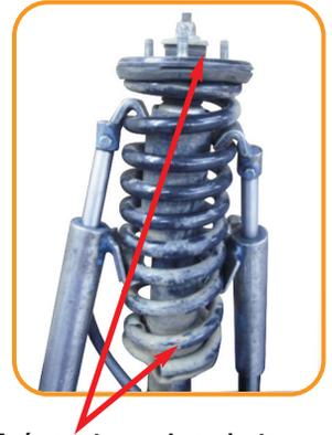
Após montagem do conjunto na bancada, efetue o processo inverso no veículo, observando que um dos parafusos do coxim deverá estar voltado para ponta da mola do prato inferior.
