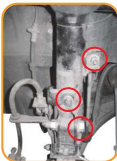
**2** Solte as porcas de fixação do coxim. Retire o conjunto e leve-o para a bancada.
