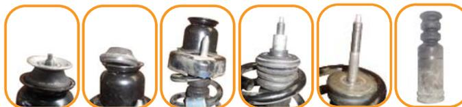
**3** Na bancada, coloque o encolhedor de molas e remova a porca de fixação superior do amortecedor, retire a arruela e a bucha de borracha superior, o prato de apoio da mola, o tubete metálico, a bucha de borracha inferior, a arruela lisa o batente e a coifa.
