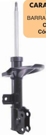
**1** Com o veículo suspenso no elevador, retire as rodas e solte as fixações do cabo do sensor ABS, a fixação do flexível de freio e a porca da bieleta.
