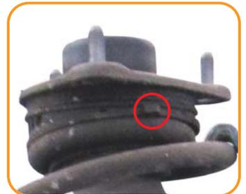
**4** Solte os três parafusos superiores do coxim do amortecedor. Retire o conjunto e prenda-o na morsa.
