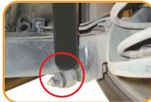
**2** Solte a porca de fixação inferior do amortecedor e o parafuso de fixação superior do amortecedor.
