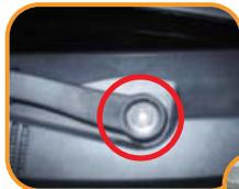
**4** Remova os parafusos da manga de eixo e solte a porca superior do amortecedor. Logo após, retire o conjunto e prenda-o na morsa.
