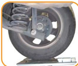
**1** Com o veículo suspenso, apoie a roda com um macaco hidráulico ou utilize um cavalete no eixo para aliviar a tensão dos parafusos e dar suporte.
