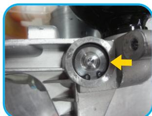
**6** Agora a válvula de não retorno está pronta para a operação de substituição.
