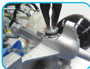
**10** Retire a válvula e descarte-a para a reposição da nova. Caso esteja dando retorno de óleo para a bomba, acondicione-a em um saco plástico isento de impurezas para testes de contaminação.
