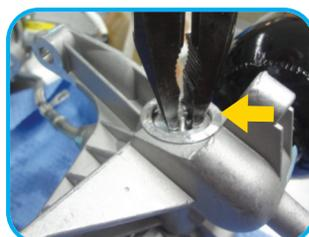
**9** Com o auxílio de um alicate universal, puxe a válvula de não retorno para fora do alojamento pelo pino ressaltado e, caso a não saia com facilidade, utilize um alicate de corte com um calço formando uma "alavanca" para facilitar a retirada.
