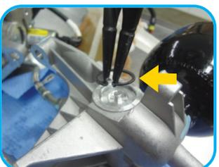
**8** Utilizando o alicate da referência acima, retire o anel trava da válvula de não retorno e descarte-o. Esse anel não deverá ser utilizado para o novo conjunto, que já virá com um anel trava novo.
