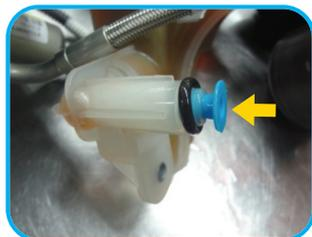
**5** Após desencaixar o tubo do reservatório de óleo do alojamento na bomba, é necessário tampá-lo com um batoque ou algo que possa impedir uma perda de óleo significativa proveniente do reservatório.
