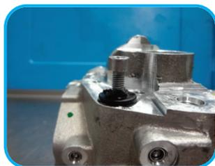
**14** Na imagem ao lado, o parafuso está posicionado de tal forma que é possível utilizá-lo como pino de extração. A forma de extrair-lo, pode variar com pequenas batidas com martelo de borracha plastificado, ou com um sacador dedicado para estes tipos de extração.
