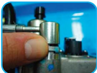
**13** Após alinhar as canaletas, coloque o fermaglio e empurre a interferência até que se encaixe sem muito esforço.
