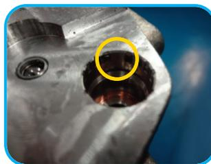
**18** Finalizando a desmontagem, observe que, entre as ranhuras provocadas pelo arraste dos dentes do snap-in da junção, existe uma parte da parede do alojamento que permaneceu lisa, isenta de ranhuras.
