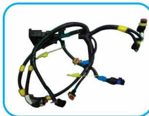
**15** Atenção na hora da montagem dos conectores pois não se pode montar errado. Utilize as identificações enumeradas das fitas adesivas coladas na desmontagem, conforme indicado no início do trabalho. Caso não o tenha feito, analise um outro Kit já montado e monte por comparação.
