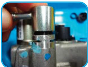
**12** Introduza o tubo para que o rasgo no usinado fique alinhado com a canaleta de encaixe e cumpra a sua função de trava.
