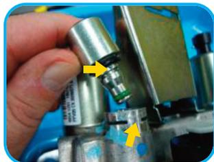
**11** Para realizar a montagem do tubo de alta pressão para o atuador CSC (Control Slave Cluth), antes insira o tubo em seu alojamento e verifique a integridade dos dois anéis o-rings. A Canaleta de encaixe do fermaglio deve emparelhar com o rasgo do usinado.
