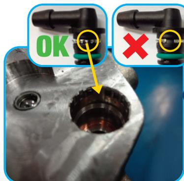
**1** Repare na imagem ao lado o detalhe da parede lisa do alojamento da junção e nas mangueiras com e sem travas do snap-in. Essas travas deverão ser direcionadas para o lado liso da parede do alojamento para um travamento mais confiável.
