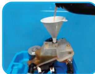
**16** Durante todo o trabalho, é possível que tenha se perdido um pouco de óleo, então, com o óleo especificado Tutela CS Speed, complete o reservatório até o limite máximo indicado, antes de montá-lo no câmbio.
