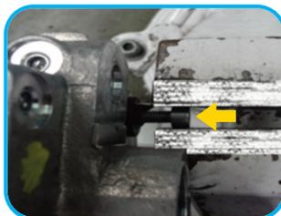
**15** Prenda o parafuso Mx6 em uma morsa e inicie a extração da junção com o auxílio de um martelo emborrachado. Não há necessidade de bater com muita força para sua extração, tomando cuidado com os componentes periféricos que permaneceram no corpo do Actuador Pack para não danificá-los.
