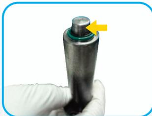
**2** Observe na imagem correto para montagem do conjunto na ferramenta é o inverso, ou seja, a parte chanfrada conforme indicado na seta ao lado para baixo de forma que, quando for encaixado no alojamento ele fique para cima para receber o eixo de seleção.
