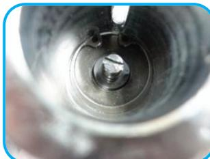
**15** Com o eixo posicionado para baixo retire o anel trava (seeger) para poder retirar também o conjunto móvel do eixo de seleção.
