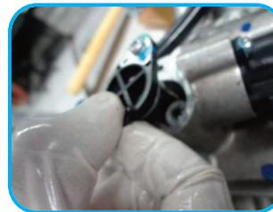
**22** Feche o alojamento do eixo de seleção com o tampão e aperte-o com uma chave torx 20. Ao acoplá-lo no eixo de seleção do câmbio, coloque o tampão somente para evitar que caiam impurezas durante a montagem. Logo após, aplique o torque no parafuso do tampão.
