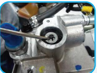
**9** O eixo calçado por baixo fica em uma posição elevada. Utilize uma chave de fenda com a ponta fina para abrir dente por dente do anel grifaxe.
