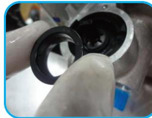
**20** Com o tracionador encaixado, coloque a guarnição de borracha. Esse item não possui lado de montagem.
