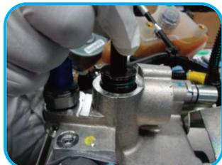
**17** Logo após, pela parte de baixo do conjunto, empurre o eixo de seleção para cima que sairá junto com o conjunto móvel completo: Eixo, arruela, bucha e anéis o-rings.
