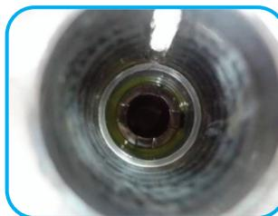
**19** A bucha de vedação inferior do eixo de seleção ainda está encaixada no fundo do alojamento sobre a arruela de posição. Esta bucha, só deve ser retirada quando ela for a causa do vazamento, e somente com ferramenta apropriada, para não danificar a parede do alojamento.
