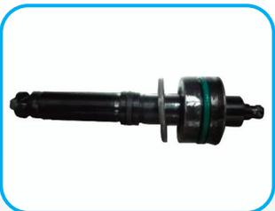
**9** O eixo de seleção deve ser montado primeiramente fora do alojamento conforme sequência ao lado: Eixo com anel grafitado, arruela e por fim a bucha de vedação superior.
