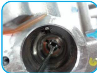
**26** O conjunto de anéis é facilmente removido e nenhum dos anéis devem ser reaproveitados, obrigatoriamente é necessário utilizar um conjunto de anéis novos que serão fornecidos junto como Kit de reposição.
