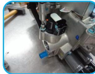
**21** Aperte o parafuso de fixação do sensor de posição, com uma chave torx 20, aplicando um torque de 3 a 4.2Nm. Em seguida, lacre-os com tinta para garantir possíveis violações.
