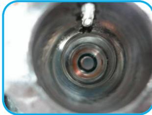
**25** Embaixo do local da arruela, encontra-se um conjunto de anéis sendo, um grafitado e um o'ring, que tem por função vedar a passagem de óleo para a parte inferior externa do alojamento, misturando-se ao óleo do câmbio.
