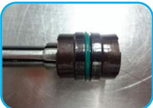
**7** Insira a bucha inferior no alojamento. Esta peça não tem lado, portanto não há o perigo de montá-la invertida, podendo ser inserida encaixada no eixo de seleção e empurrada para baixo com força moderada.
