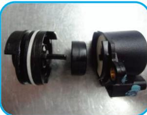
**18** Após essas operações, será necessário o início da montagem do conjunto do sensor de posição do eixo de seleção: Tracionador, guarnição e o sensor de posição.
