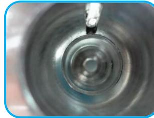
**28** Agora o alojamento usinado do conjunto eixo de seleção está completamente livre de componentes fixos e móveis. As suas paredes devem estar isentas de arranhões e impurezas que possam causar danos para a instalação das peças novas.
