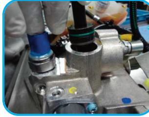
**10** Após a montagem fora do alojamento, o conjunto do eixo deve ser inserido com cuidado, de forma manual em seu alojamento, com anel O'ring lubrificado, sempre com os mesmos cuidados com impurezas, torções e cortes de anéis o'ring.
