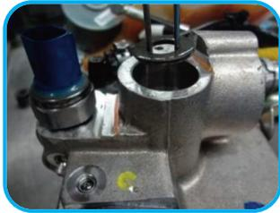
**5** Em seguida posicione a arruela conforme imagem. A arruela não tem lado para montagem, porém verifique se está de forma plana sobre o conjunto de anéis, pois sobre ela será apoiado a bucha de vedação inferior que virá a seguir.
