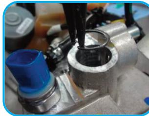
**12** O anel elástico seeger deve ser colocado com um alicate apropriado para a retirada de anéis elástico e, após a sua inserção, gire-o no seu alojamento garantindo que está girando livre e não irá escapar.
