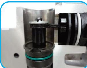
**19** Antes de encaixarmos o tracionador no seu alojamento, garantir que a ponta da leva A do eixo de seleção fique encaixada no rasgo do came B do tracionador. (Ao encaixar a leva, movimentar o eixo de seleção e verificar que o came do tracionador esta acompanhando-a o movimento).
