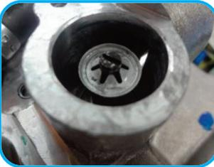
**17** Na falta do dispositivo, pode-se tentar usar outros meios para encaixar o anel, como um tubo metálico vazado com diâmetro específico, porém deve-se sempre observar o resultado da operação, pois a leva não pode ficar com folga no eixo de seleção.
