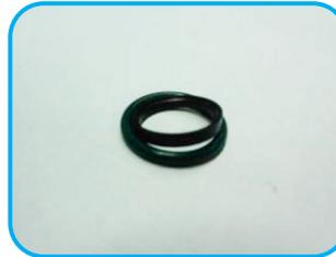
**27** Na imagem do anel grafitado e do anel o'ring de vedação, é possível observar que o diâmetro interno do anel grafitado tem posição de montagem. A sua parte chanfrada deve ficar para cima de onde será inserido o eixo de seleção e no seu diâmetro externo deve ficar encaixado no anel o'ring.
