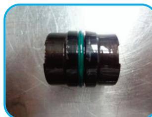
**22** Geralmente, a troca desta bucha é necessária quando o anel o-ring de vedação se rompe, causando a ligação da parte inferior do canal com a parte superior, fazendo com que o eixo de seleção perca sua função, pois a pressão hidráulica irá ligar as duas câmaras, inferior com a superior.
