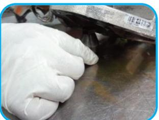
**8** Para retirar o anel grifaxe com facilidade é necessário manter o eixo de seleção para cima (posição de 5° e Ré), para isso, utilize um suporte na parte inferior do Actuador Pack, que apoiará somente o eixo como um calço.
