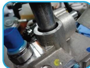
**3** O encaixe deve ser feito com cautela para não danificar o conjunto dos anéis. A força usada no trabalho deve ser manual e moderada.
