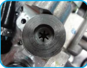
**16** Para este encaixe a Magneti Marelli tem um dispositivo apropriado que garante o alinhamento do anel para receber uma punção de forma a receber a aplicação de uma força de inserção, através de um martelo comum ou de um automator.
