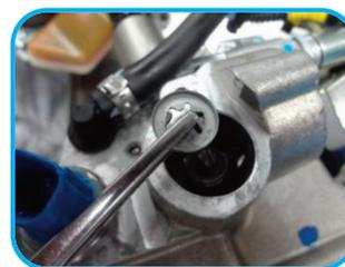
**10** Após destravar os dentes do anel puxe-o e descarte-o. Somente um anel grifaxe novo poderá exercer esta função com segurança da válvula. Mantenha a boca do filtro de óleo para baixo.
