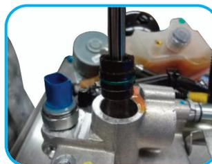
**21** O sacador da bucha inferior encontra-se no seu diâmetro interno, expandindo-se, criando uma pressão mecânica que permite sua retirada.
