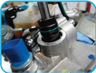
**8** O anel deve ser lubrificado com o mesmo óleo usado para funcionamento do **Kit Tutela CS SPEED**. Aponte a bucha e alinhe-a colocando uma força de inserção moderada.
