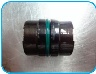
**6** Logo após, monte a bucha de vedação inferior, garantindo que ela chegue ao seu batente para que o canal de passagem de óleo sob pressão não fique obstruído, sempre observando os cuidados com o anel externo quanto a cortes, torções ou contaminação por impurezas.
