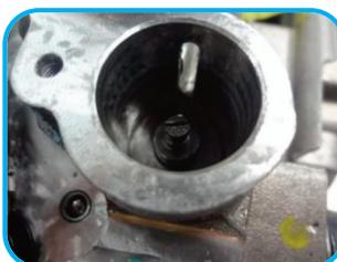
**11** Com uma pinça comum retire a leva da ponta do eixo de seleção. Esta leva poderá ser reutilizada sem problemas tomando cuidados com a limpeza e choques mecânicos.
