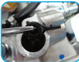
**12** Na ponta da leva existe uma **Graxa\*\***, que serve para aliviar o atrito mecânico entre ela e as paredes do rasgo de deslocamento, a qual deverá ser reposta numa quantidade de aproximadamente 20 gr, após a montagem.
