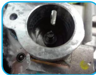
**11** Já com o eixo dentro do alojamento, force o conjunto para baixo até a posição necessária para travá-lo. Essa operação deve ser realizada através de um tubo vazado cujo diâmetro deve ser o suficiente para o eixo de seleção poder adentrar em seu interno. Importante: realize essa operação com um novo anel trava (seeger).
