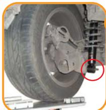
**1** Com o veículo suspenso, apoie a roda com um macaco hidráulico ou utilize um cavalete no eixo para aliviar a tensão dos parafusos e dar suporte. Logo após, solte a porca de fixação inferior do amortecedor, porém, não o retire do pino ainda.
