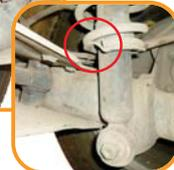
**7** O aperto dos parafusos do amortecedor traseiro deve ser feito utilizando um torqueímetro, ajustado de acordo com as especificações da montadora, e com o veículo no solo, para evitar danos à bucha do amortecedor.
