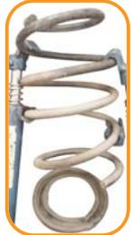
**6** Monte todas as peças do conjunto na bancada acompanhando a sequência correta dos componentes e, em seguida, monte o conjunto no veículo, alinhando primeiramente os furos do prato superior e inferior da mola, e depois, o corte do prato superior da mola com o ressalto do calço superior e a ponta superior da mola:
