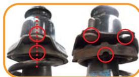
**4** Na bancada, coloque o encolhedor de molas, solte a porca e remova a arruela côncava (neste caso sua posição correta é com a extremidade voltada para cima), prato superior da mola, os coxins com tubete metálico, o encosto superior da mola, o batente, a coifa e a mola helicoidal.
