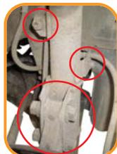
**2** Solte a porca da bieleta, o flexível de freio e os parafusos da manga de eixo.
