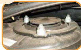
**4** Na bancada, coloque o encolhedor de molas e remova o guarda-pó, a porca, o coxim, o prato superior da mola, a coifa, o batente, a mola helicoidal e o calço inferior da mola.
