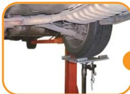
Com o veículo suspenso, apoie a roda com um macaco hidráulico (ou cavalete) no braço de suspensão, para aliviar a tensão dos parafusos e dar suporte.
